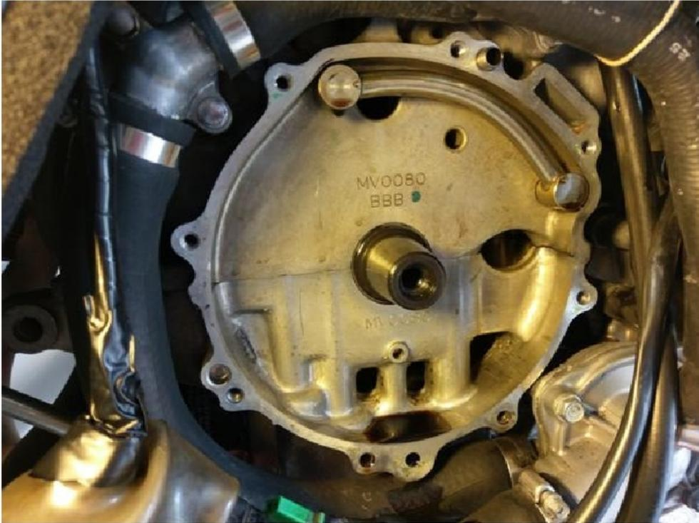
Ultimo accorgimento: i tre cavi in uscita dall'alternatore passano tra la V dei cilindri e sbucano sull'altro lato della moto, nei pressi della trave del telaio, dove – originariamente – erano accoppiati a quelli in entrata del regolatore per mezzo di due connettori (m/f) che si sono cotti già un paio d'anni fa. Io non li ho sostituiti: mi sono limitato a saldare i cavi tra loro, ricoprendoli con adeguato isolante, e via... ;-)
